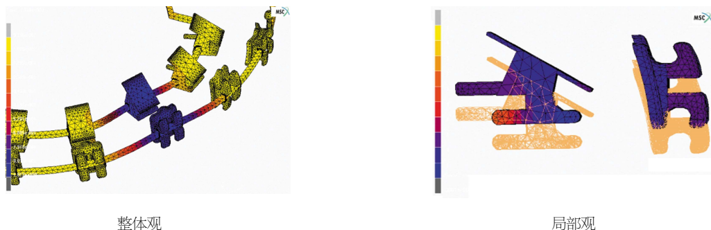
图 2 模型加载位移压入 1 mm 前后左上中切牙托槽受力云图
